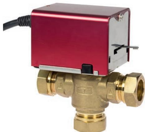
Las 3PV2 y 3PV8 son válvulas de 3 vías que disponen de mecanismo con muelle de retorno a la posición central y de servomotor. Se fijan por la entrada y las 2 salidas teniendo en cuenta la señal que indica el sentido de circulación del fluido y pueden ponerse en funcionamiento manual o automático con una palanca. Por el lado de entrada se produce la alimentación de agua limpia y las 2 salidas conducen al sistema de calefacción central (A) y al de calentamiento de agua (B).
